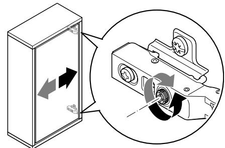
Öffnungsmechanismus einstellen | Réglage du mécanisme d'ouverture | Regolazione del meccanismo di apertura
