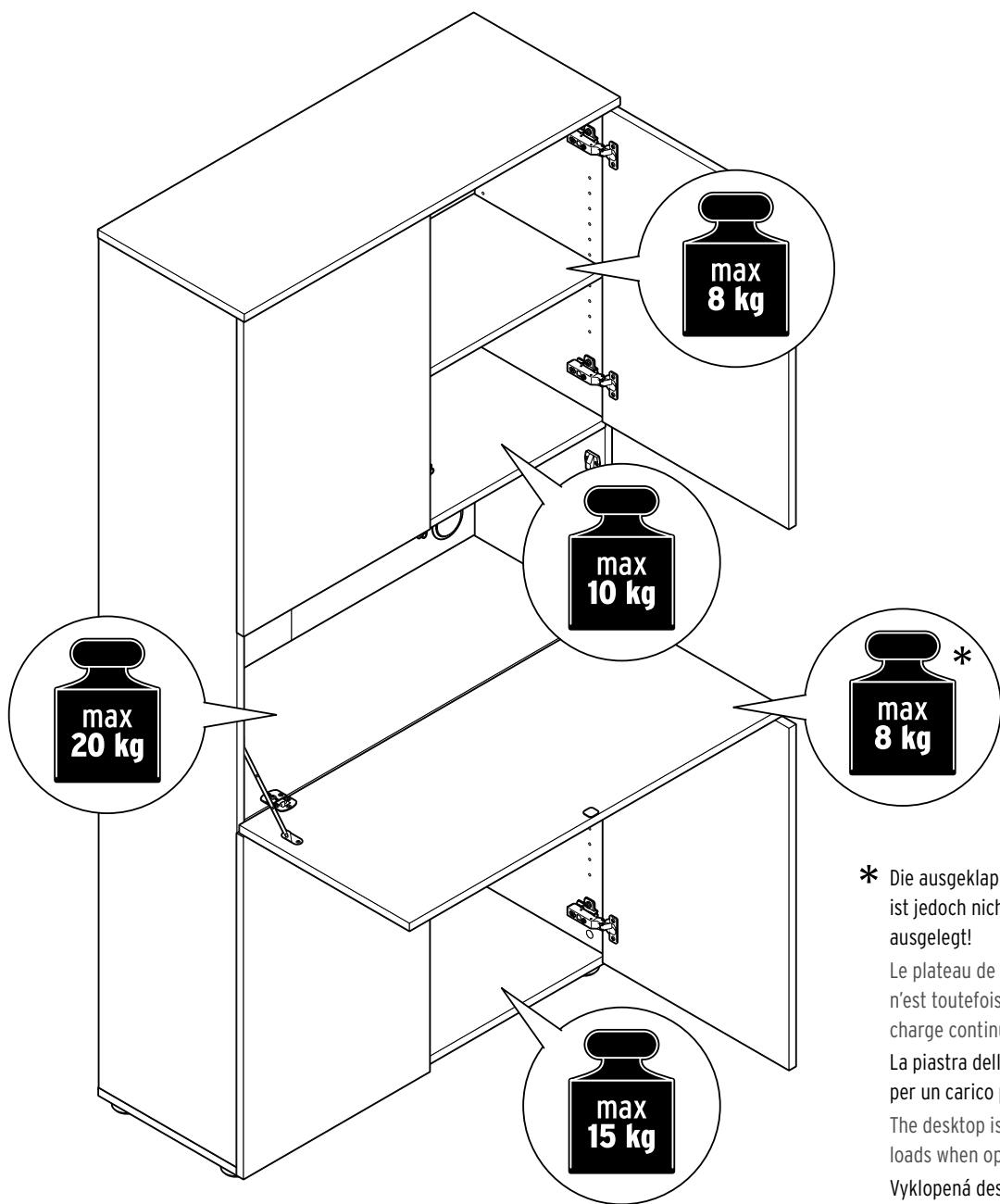
\* Die ausgeklappte Schreibtischplatte ist jedoch nicht für eine dauerhafte Belastung ausgelegt!
